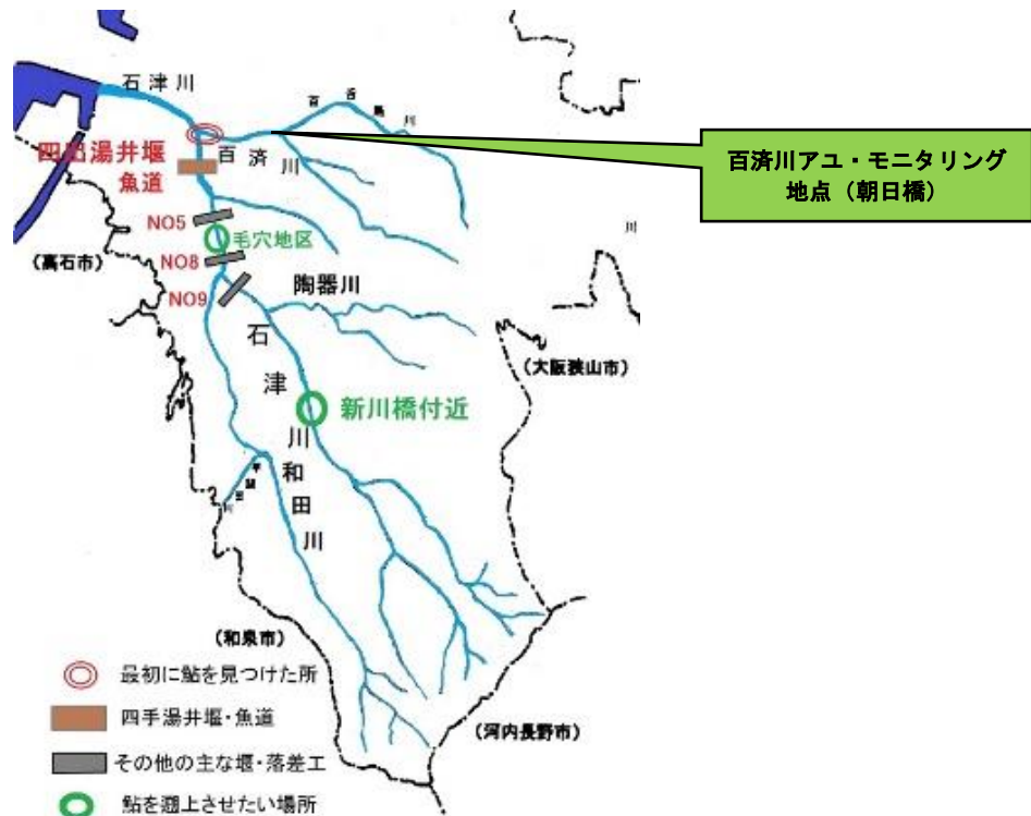
図1 石津川の主要な横断構造物
